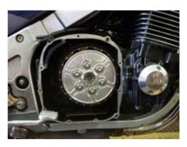
wenn die neue Dichtung nicht zwei schmale Streifen / flache Wulste in diesen Bereichen aufweist, muß zwingend!
