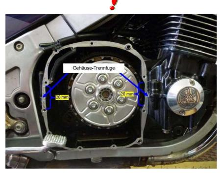
(neuen) Deckel samt neuer Dichtung wieder drauf und alle Schrauben mit 10 Nm angezogen
