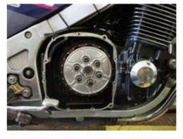
neue Schraube samt der speziellen U-Scheibe für die neuen Federn.
