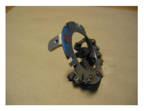
Die Grundplatte wird in den Deckel geschoben und beide Teile werden durchgebohrt. Den Deckel bohrt man etwas auf.
