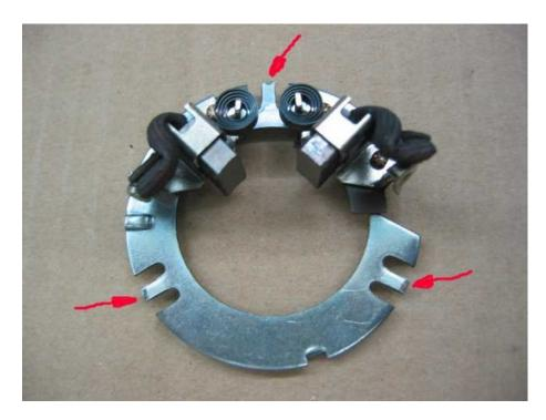
Diese Kontaktprobleme können zu starker Wärmeentwicklung führen, was zur Schwärzung der Kontakte führt. (siehe rote Pfeile).
