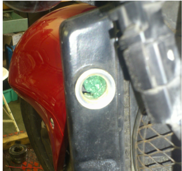
Schlammpfropfen im Kühler
