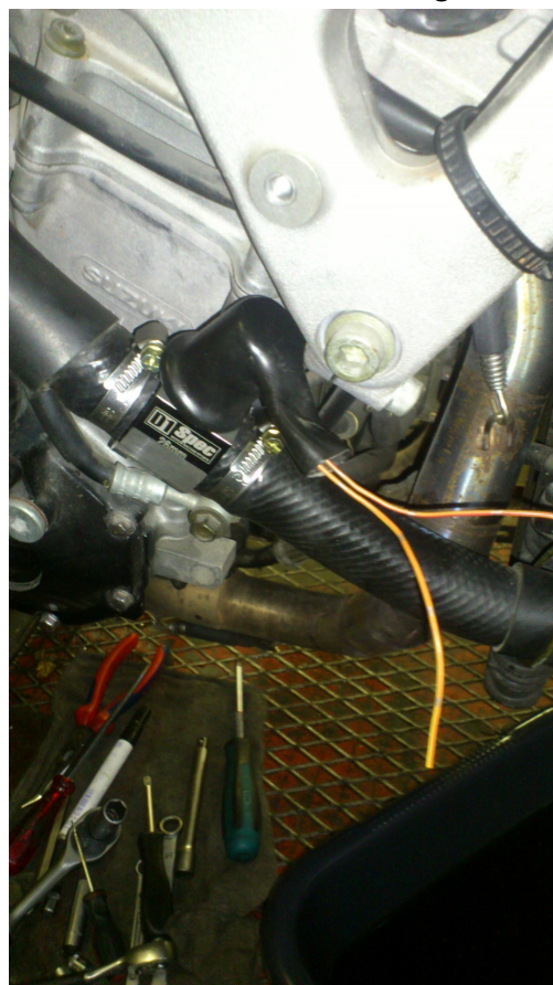
Bild 4 - Stecker auf Fühler aufgesteckt
