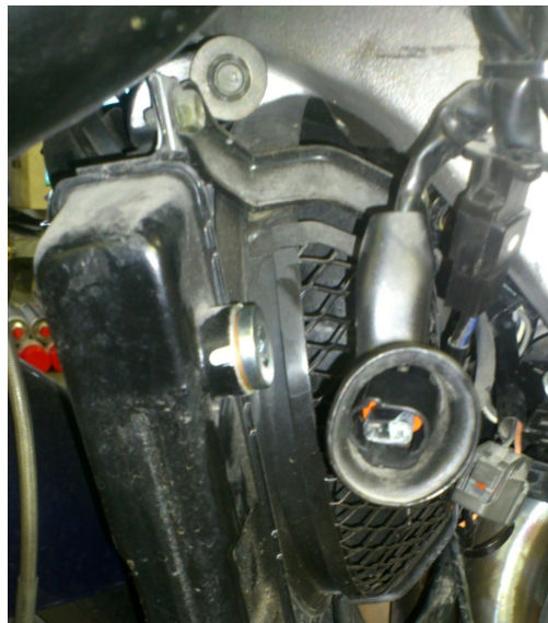
Bild 4 - Stecker auf Fühler aufgesteckt
